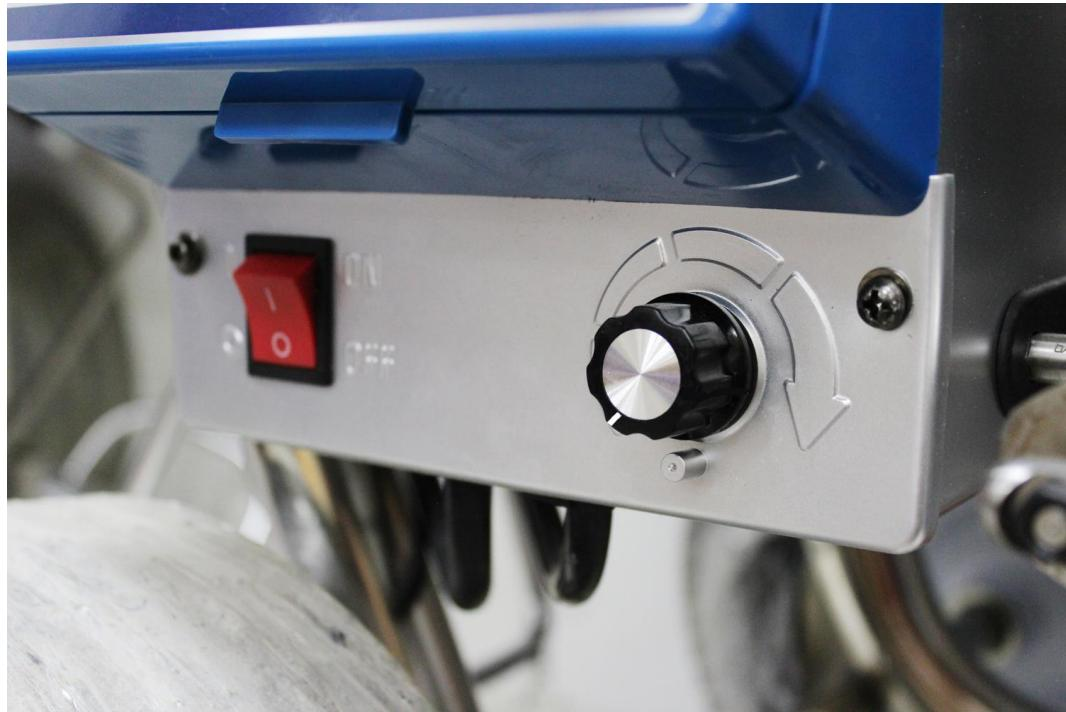
**8.** Переведите выключатель сети в положение «I» (включено) для включения Электронной части управления двигателем.
