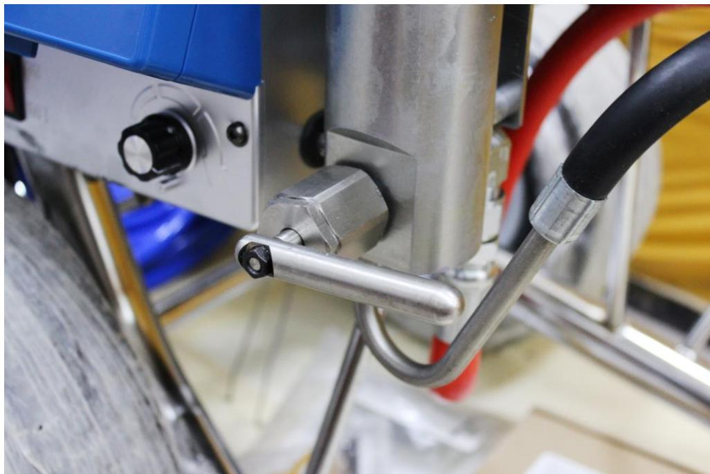
**11.** Прижмите пистолет к емкости с жидкостью для промывки. Снимите курок распылителя с предохранителя и нажмите. Не отпуская курок увеличьте число оборотов двигателя с помощью регулятора давления жидкости повернув его на  $1/2$  по часовой стрелке. После того как жидкость пойдет из пистолета, отпустите курок, позволив аппарату набрать давление. Величину давления можно наблюдать на дисплее. Проверьте наличие утечек.
