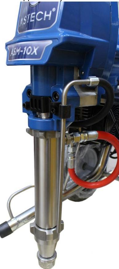
**7.** Убедитесь, что регулятор давления установлен на минимальном значении, то есть повернут против часовой стрелки до упора.
